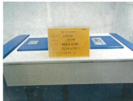
사진 1-1 IP5X 시료 설치
