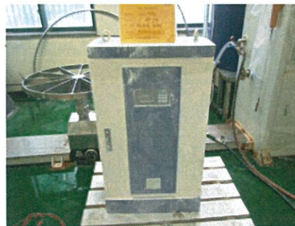
사진 2-1 IPX4 시료 설치
